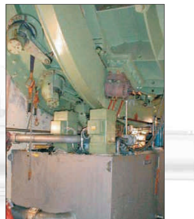
2 Насосы гидроподъема L3HF (полупогружная версия)
